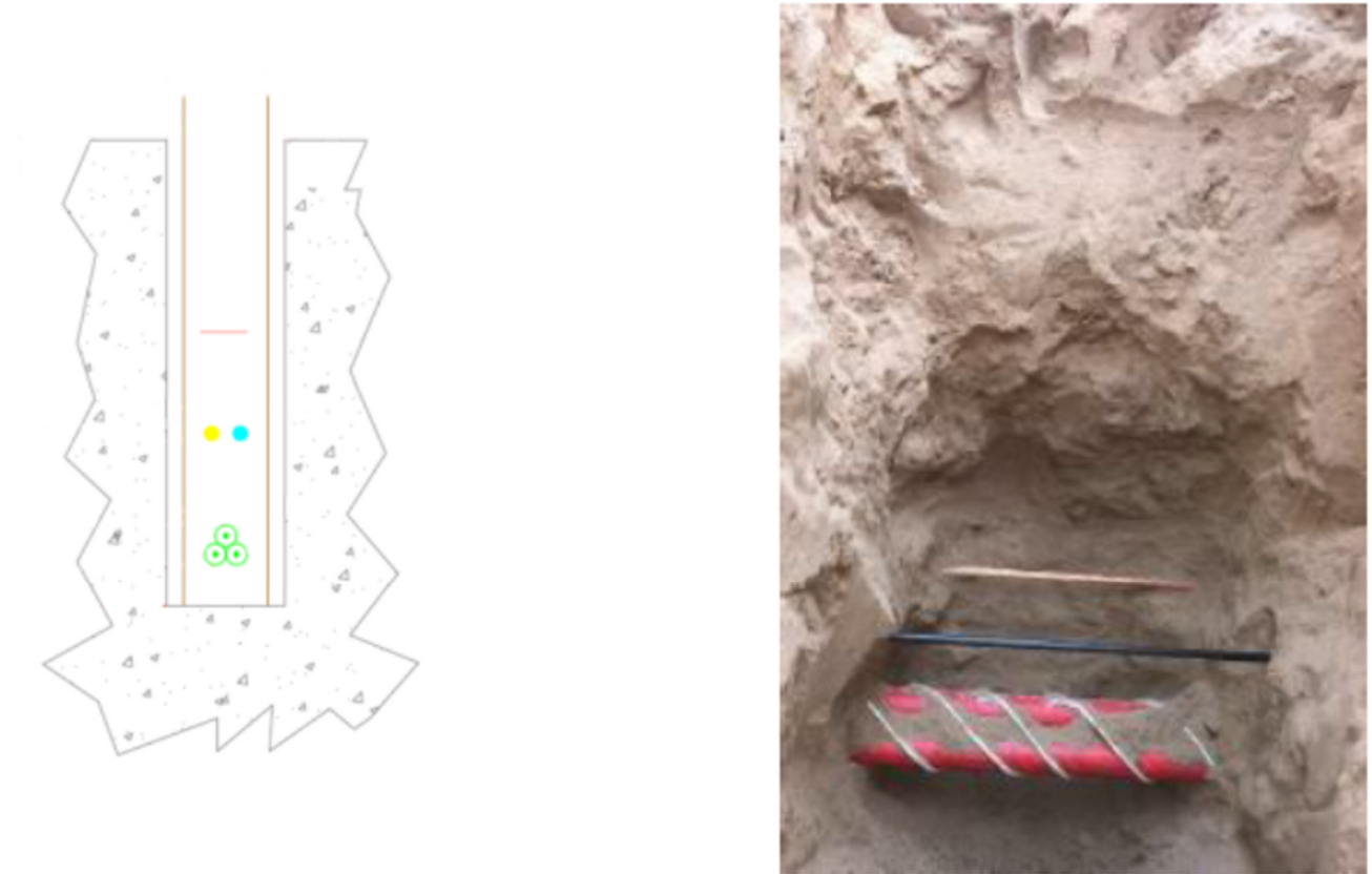
Abbildung 3: Beispielansicht für einen optimierten Grabenaushub und die reale Kabelposition
