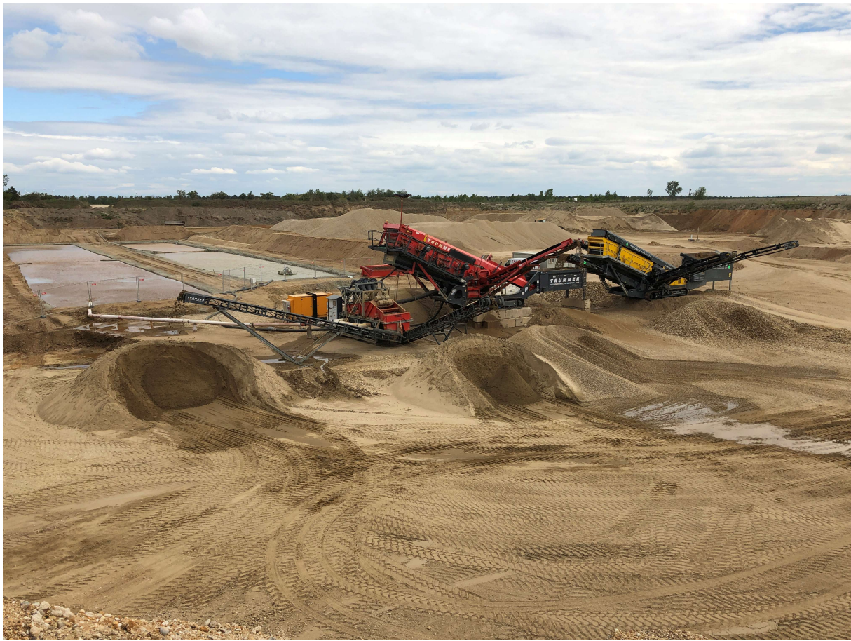
Abbildung 2: mobile Kiesaufbereitungsanlage, dahinter die Absetzbecken für das Waschwasser für den genehmigten Kiesabbau auf Allbau I und Allbau II.
