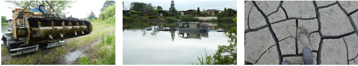
Abbildung 14: Saugmodul (links), Schwimmmodul (Mitte) und Sediment nach der Entwässerung über eine Saison im Absatzbecken (rechts) am 31.05.2024 in Zwerndorf
