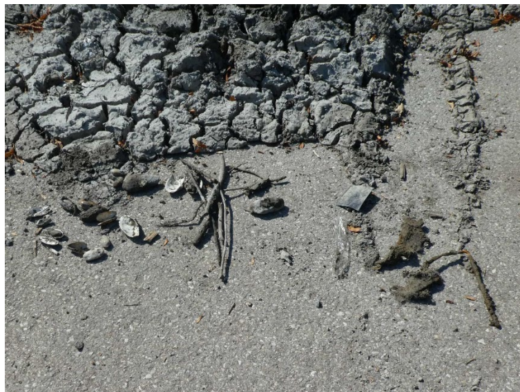
Abbildung 13: Störstoffe bei der Probegaggerung am Westufer des Schlossteiches nach der Trocknung: Links: Muscheln; Mitte: Äste und ein Stein; Rechts: Kunststoffteile (rechteckige Platte und Teil eines Einkaufsbeutels), Textil und ein Bewehrungsseisen mit Textilanhaftungen;
