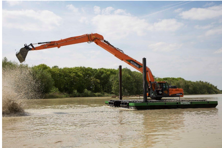
Abbildung 16: Amphibischer Schwimmbagger der Marke Waterking (Waterking B.V. 2024)
