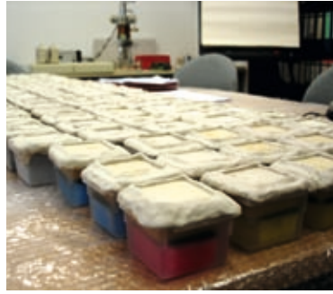
Feuchtedurchgangsmessung an den Prüfkörpern
