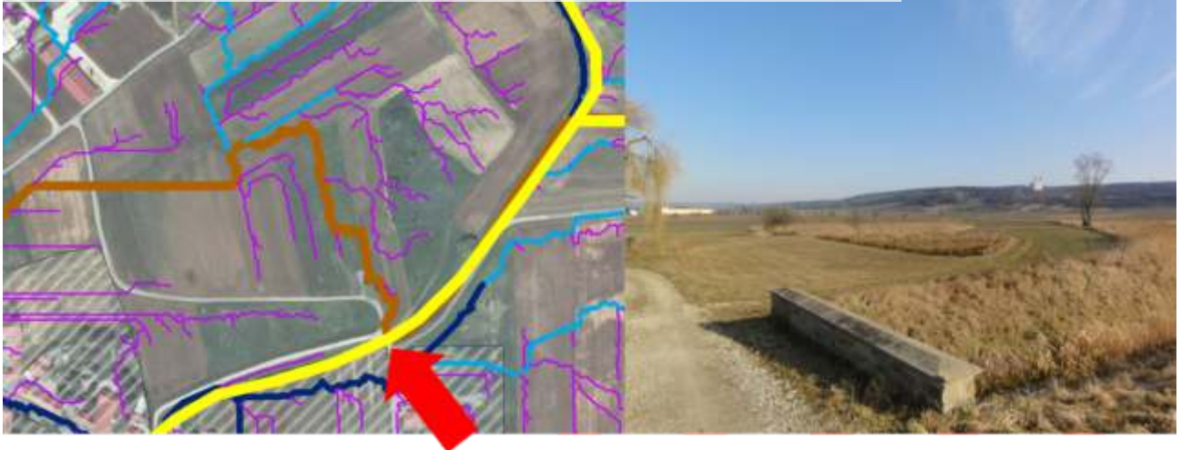
Abb. 2: Falscher Fließweg wegen des Fehlens der Brückenöffnung im Geländemodell
