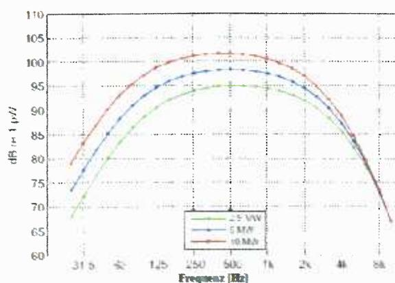
Die **Vergrößerung der Anlagen hat sowohl stärkere als auch zunehmend niederfrequente Schallemissionen zur Folge<sup>ii</sup>**. Windkraftanlagen sind somit exzellente Erzeuger von luftgeleitetem **Infraschall<sup>iii</sup>**. Die stärksten und zudem impulshaltigen Schallemissionen entstehen beim Passieren von turbulenten Luftströmungen im Turmschatten durch die Rotorflügel.
