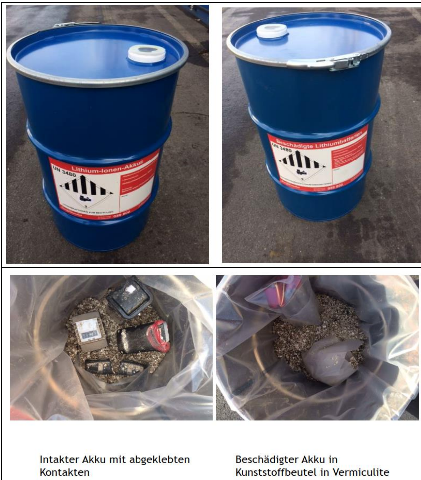
Abbildung 1: Metallfass für Li-Batterien (oben), Inlay-Kunststoffbeutel mit Vermiculit (unten). (Quelle: Saubermacher AG)
